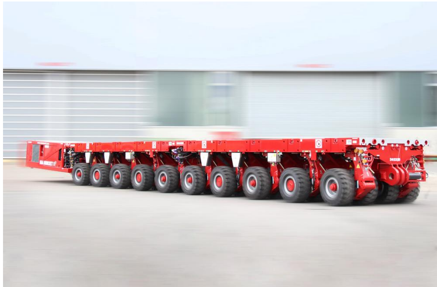
Figuur 10-53 een foto een twee gekoppelde SPMT voertuigen.
