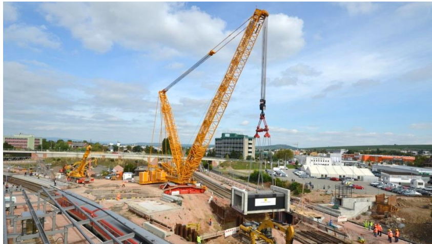
Figuur 10-52 een foto van de Liebherr LR 1750 rupskraan, in de opstelling zoals deze gebruikt kan worden voor het hijsen van zware lasten.
