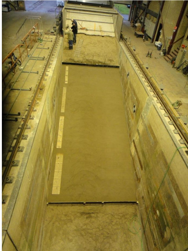
a) Opbouw model: zandcementstabilisatie klaar
