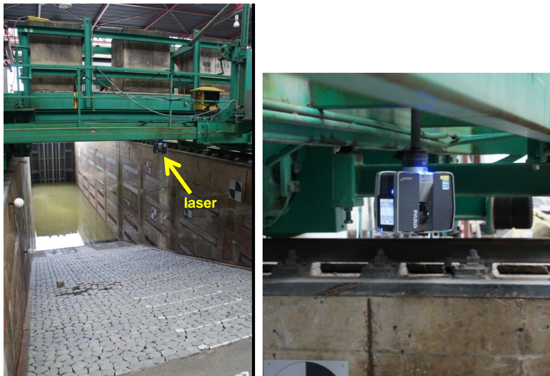
Figuur 3.7 Profielmeting met laser
