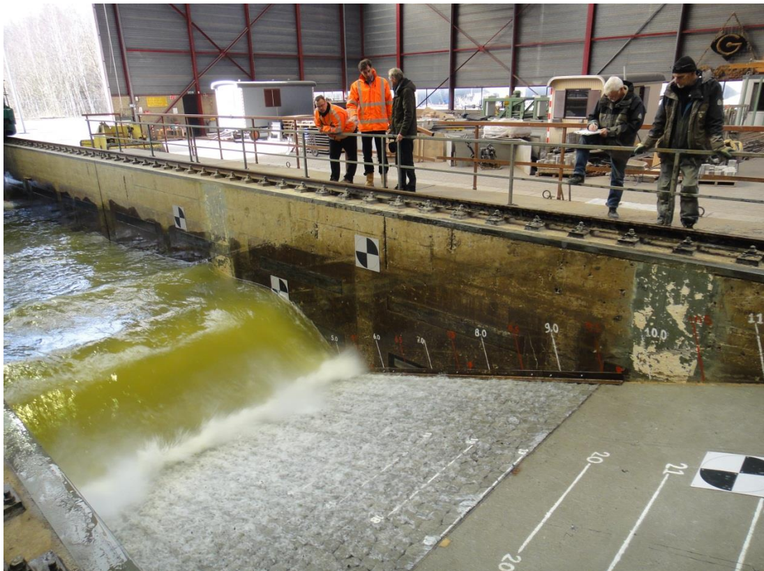
Figuur 2.1 Golfaanval op Basalton 30 STS in de Deltagoot
