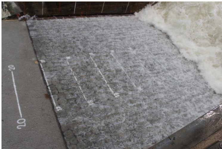
Figuur 4.2 Tijdens de golfneerloop lijkt er water uit de bekleding te komen en was er sprake van uitspoeling van inwasmateriaal
