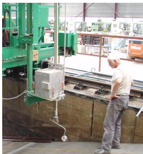
Figuur 3.8 De profielvolger vlak voor een meting.
