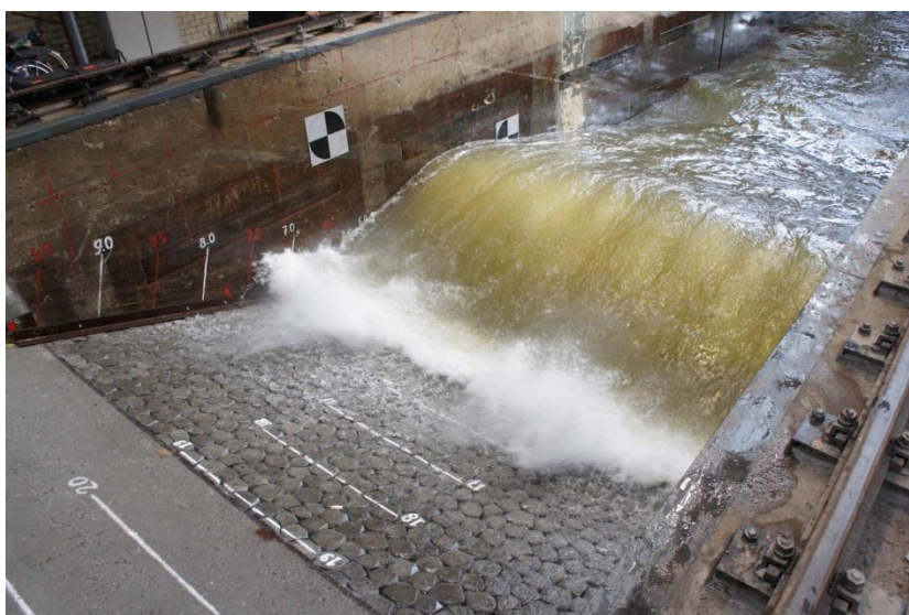
Figuur 5.4 Golfklap op Basalton 30 STS tijdens proef P07.
