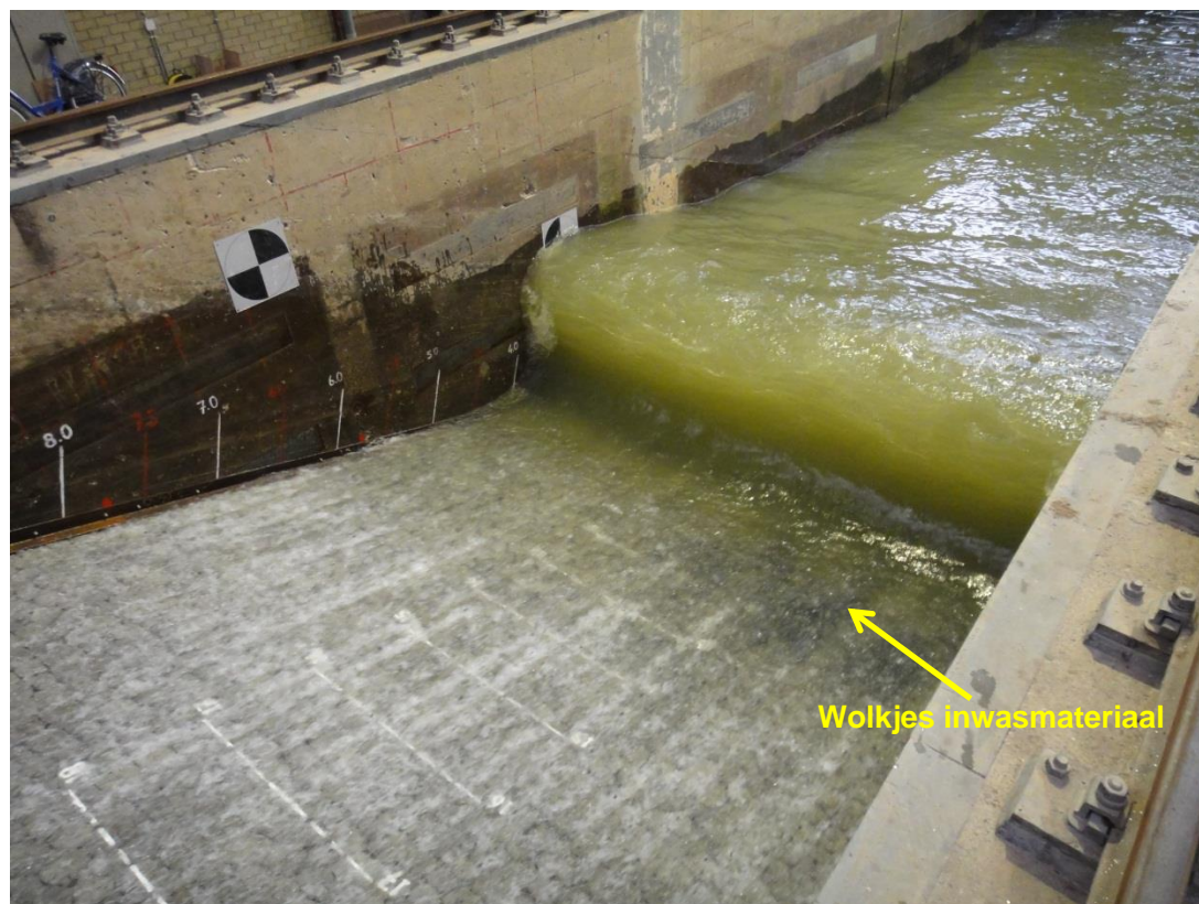
Figuur 4.3 Uitspoelen van inwasmateriaal: er zijn duidelijk wolkjes van inwasmateriaal te zien die zich over de steenzetting heen bewegen
