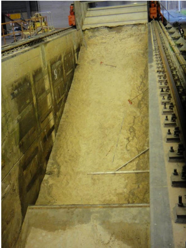
a) Opbouw model: aanbrengen zandcementstabilisatie
