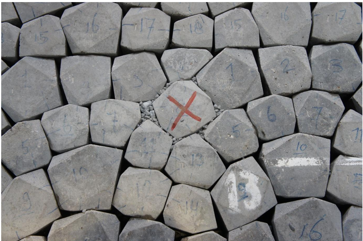
b) Serie 3: Herstel na Proef 10 (blok 8 opnieuw geplaatst en ingewassen)
