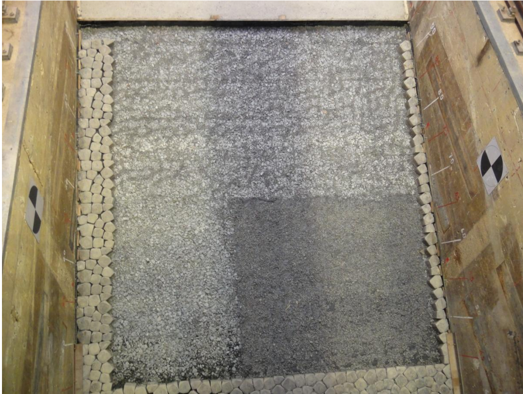
a) Serie 3: Na Proef 13 (verwijderen van steenzetting)
