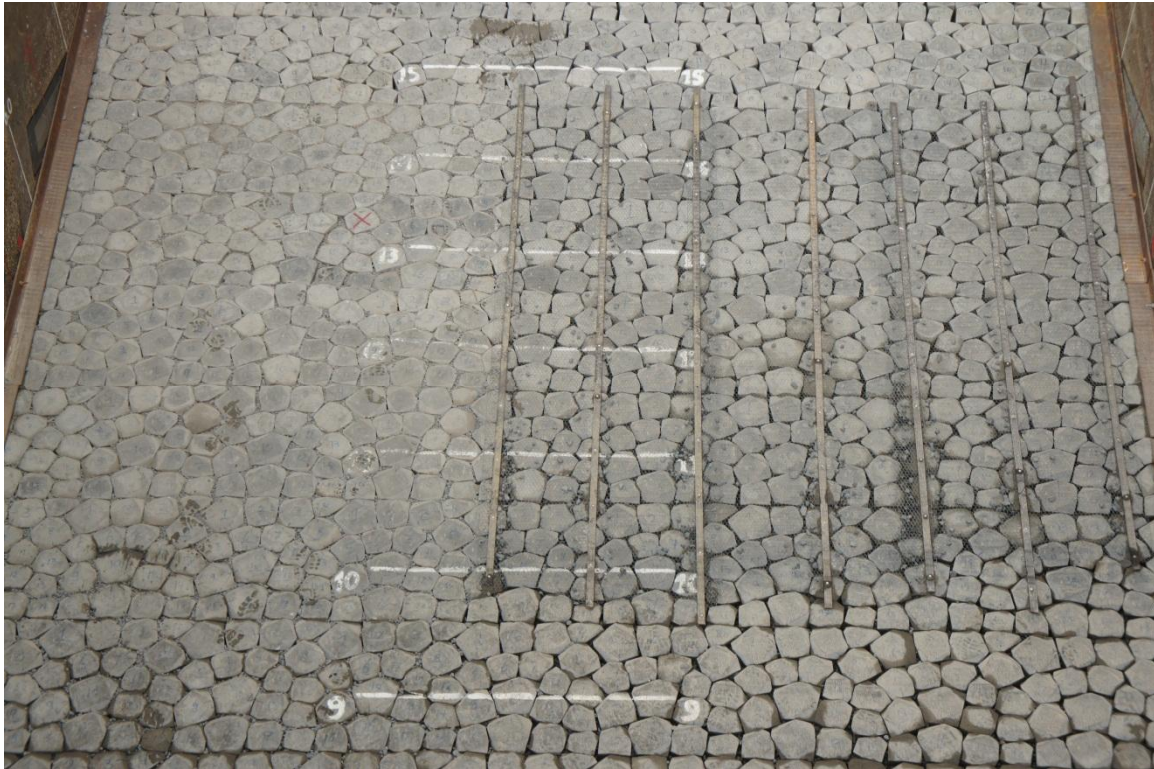
a) Serie 3: Herstel na Proef 11 (blokken terug op positie en ingewassen)
