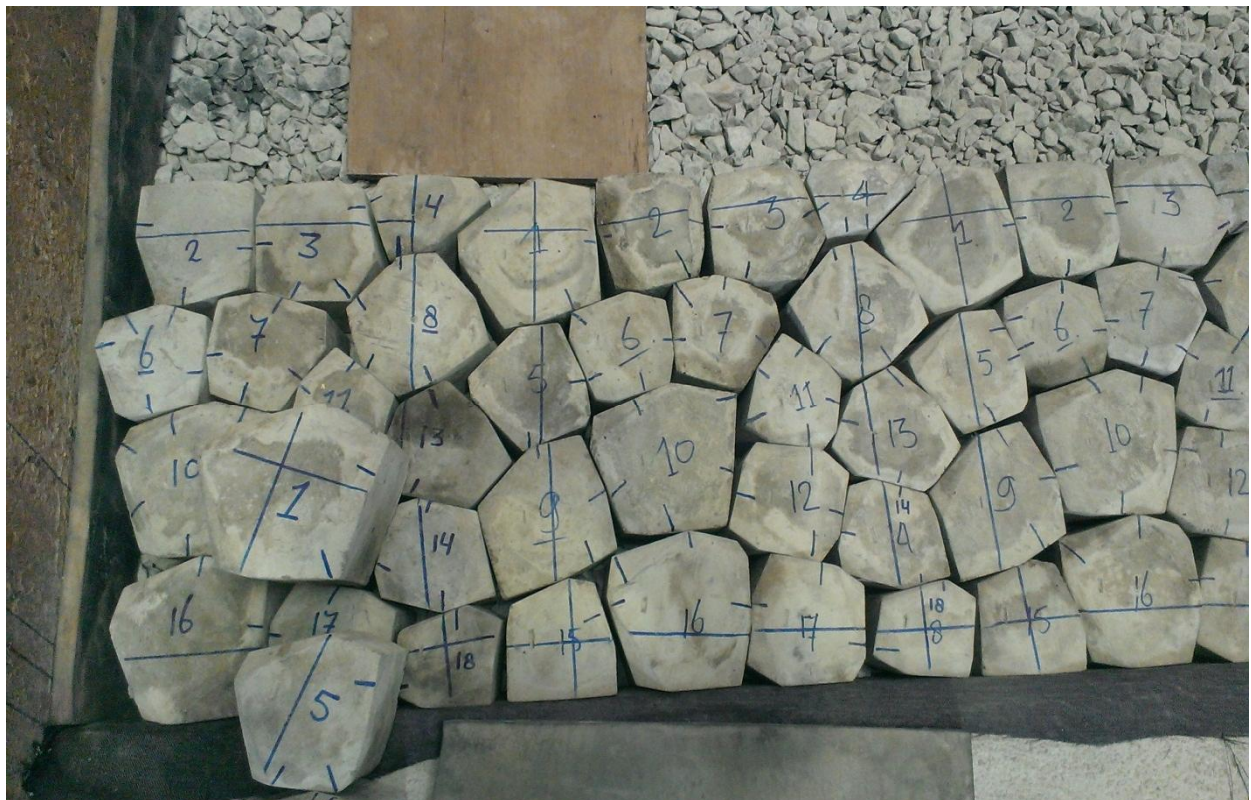
b) Opbouw model: plaatsen van steenzetting volgens palletpatroon
