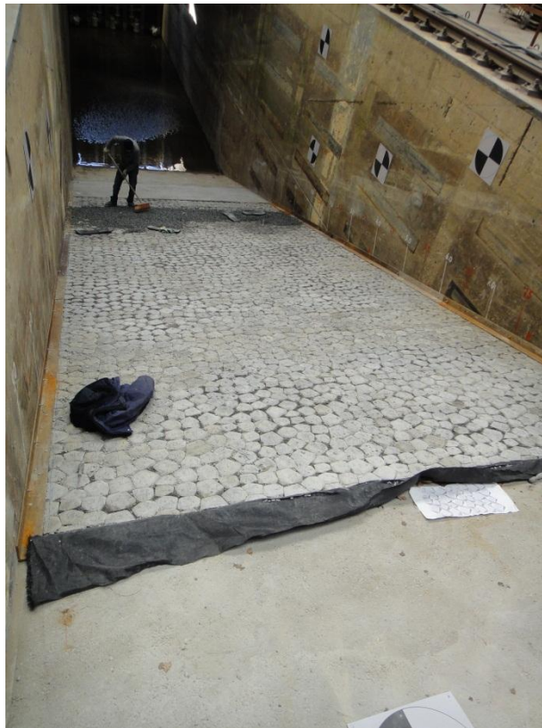
a) Opbouw model: inwassen van steenzetting
