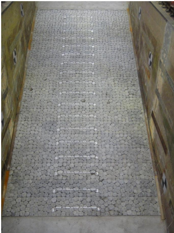
b) Opbouw model: ingewassen steenzetting
