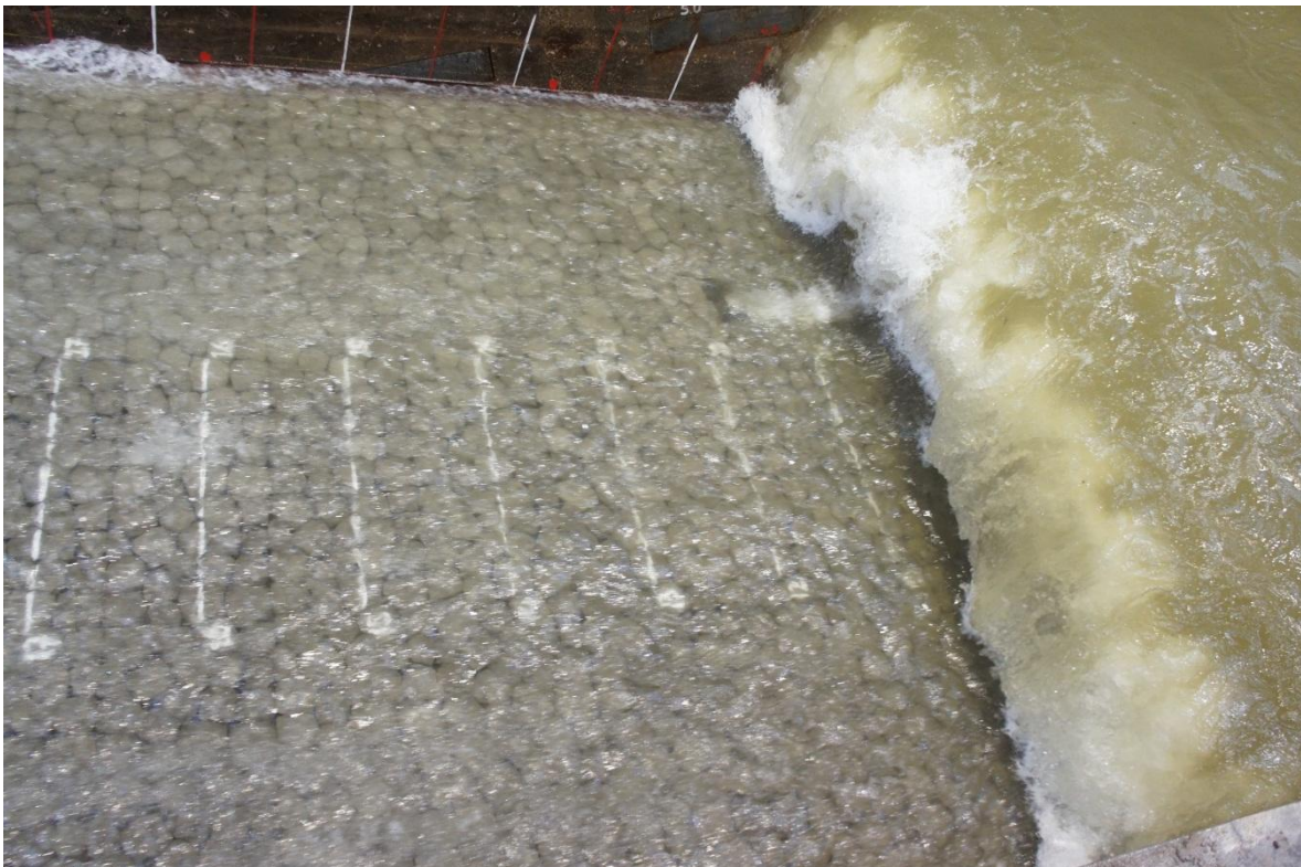
b) Serie 1: Tijdens Proef 3 (Eerste blokken eruit; na 50min)
