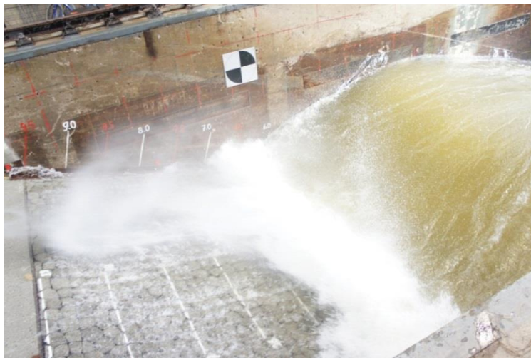
Figuur 4.1 Beproeven van Basalton 30 STS zuilen in de Deltagoot (Tijdens Proef 07)
