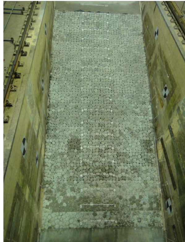
b) Serie 2: Herstel van talud (met nieuw filter en inwasmateriaal)
