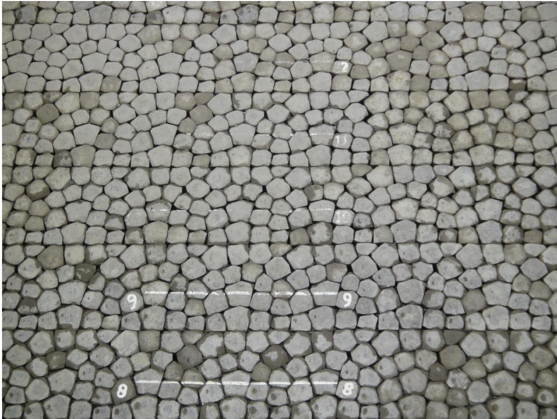
a) Serie 1: Na Proef 2 (Sterke uitspoeling van inwasmateriaal)
