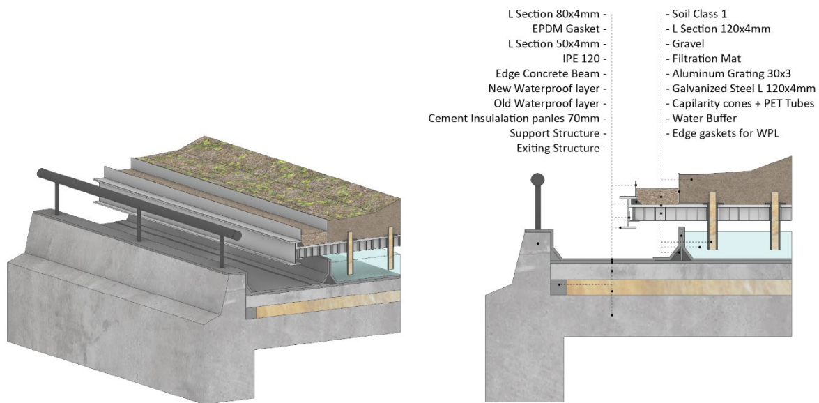
Figure 88 - Edge detail 1
