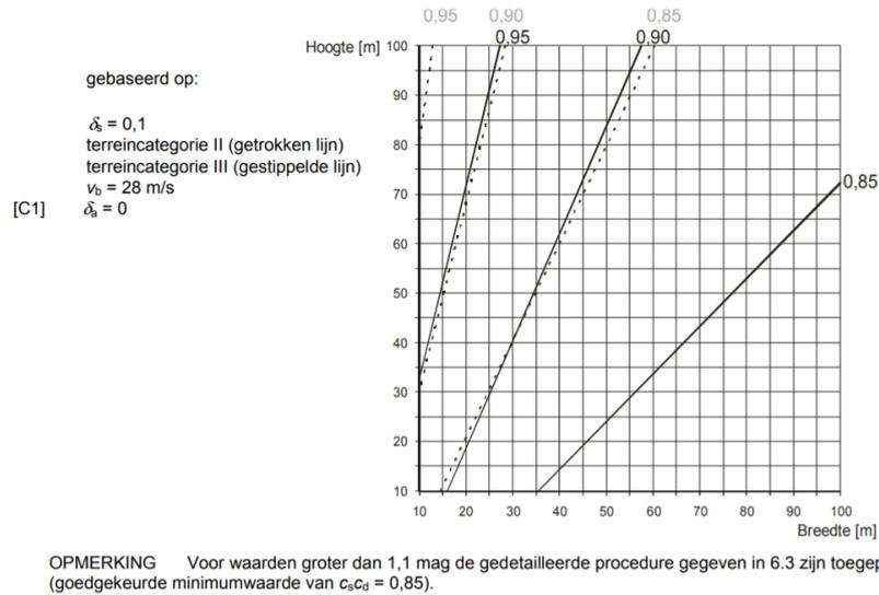
**Figuur D.2 —  $c_s c_d$  voor betonnen gebouwen met meer verdiepingen met rechthoekige plattegrond en verticale gevels met een regelmatige verdeling van stijfheid en massa (frequentie volgens uitdrukking (F.2))**
