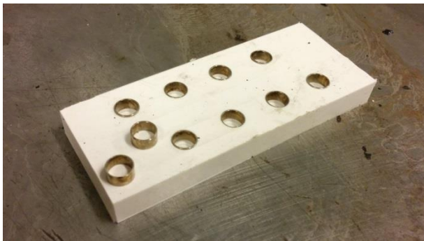
Figuur 4 Rubberen mal voor het vervaardigen van de proefstukjes
