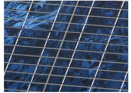
fig. 3.2.5: close-up poly c-Si solar module
