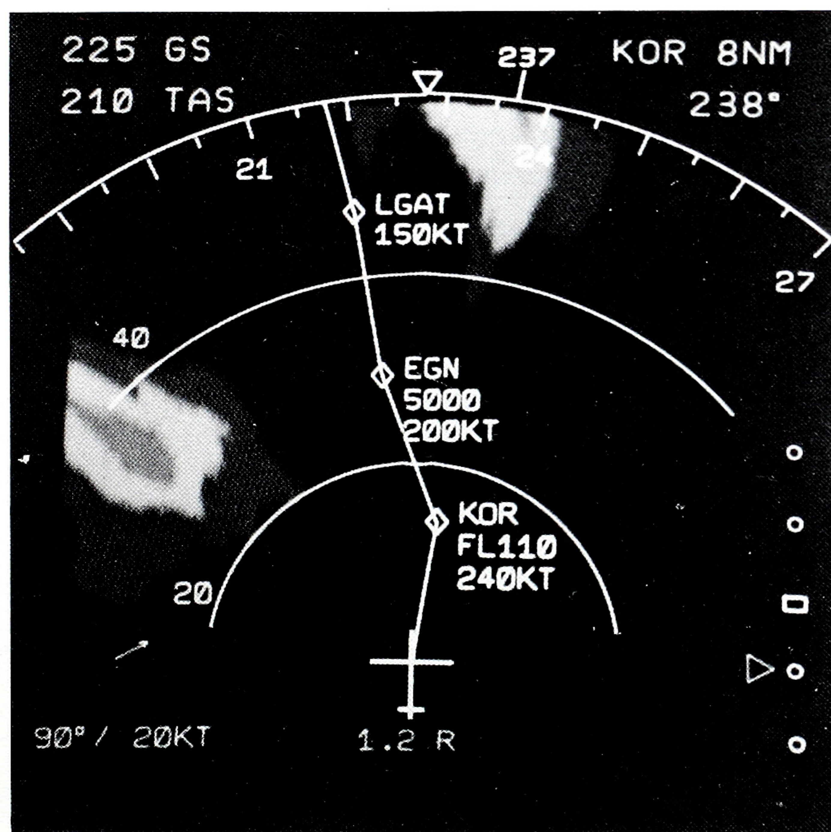
Figuur 7 - "Navigation Display" van de Airbus A-310
