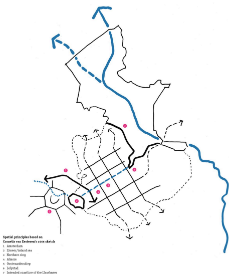
Afbeelding 10.1.3 Stedenbouwkundige plananalyse van een niet-uitgevoerd ontwerp op regionale schaal van Cornelis van Eesteren voor Amsterdam en de IJsselmeerpolders uit 1966 (boven). In de analysetekening (onder) wordt gebruik gemaakt van de technieken 'reduceren' en 'toevoegen'. Zo is het plan geplaatst in een grotere kaart van het IJsselmeergebied en zijn verkeers- en waterstromen aangegeven met pijlen in verschillende kleuren. (bron: Palmboom, 2018, pp. 313-314.)
