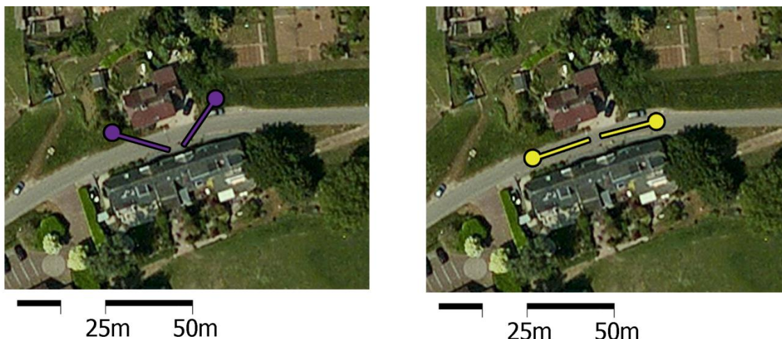
Figuur E-4 Plaatsing van de heistelling, tussen de huizen rechts en naast het huis links.
