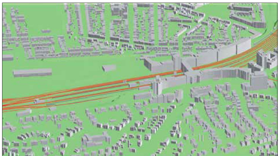
Figuur 2 - 3D-input-gegevens (geluidbronnen zoals spoor en wegen, terrein, geluidschermen, gebouwen) voor geluidsimulatie rond station Amersfoort, Bron: dBvision en GeoNext.
