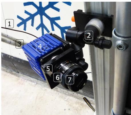
Figure 4.3: 1) BNC cable - 2) Multi-angle mount - 3) MDR cables - 4) sCMOS camera - 5) Scheimpflug adapter - 6) Lens - 7) Bandpass filter
