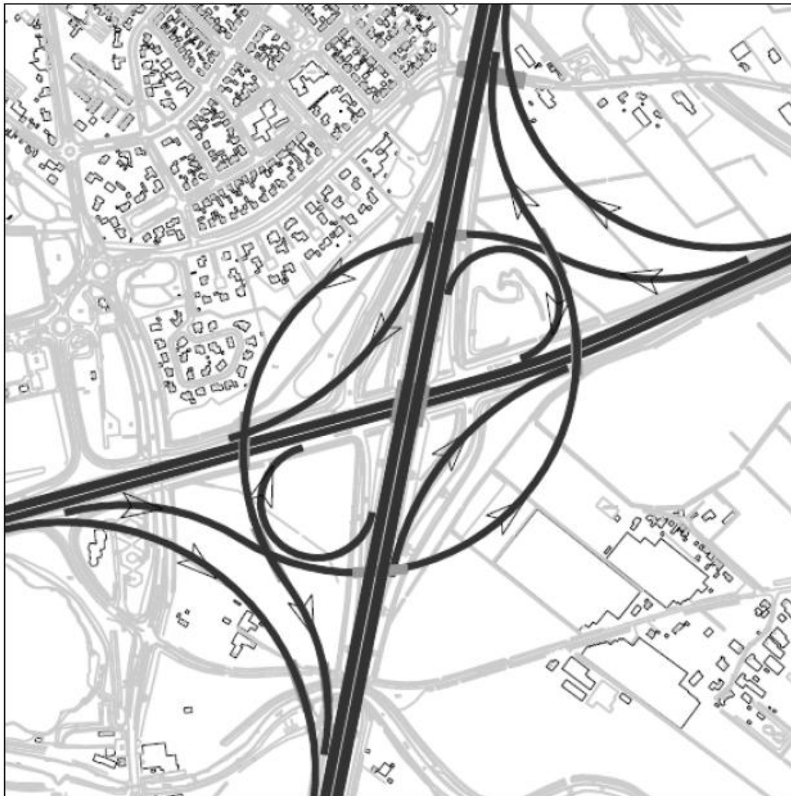
Figuur 53: Voorbeeld van een viltstiftenschems uit het Kader Wegontwerpproces van Rijkswaterstaat (Rijkswaterstaat, 2019)
