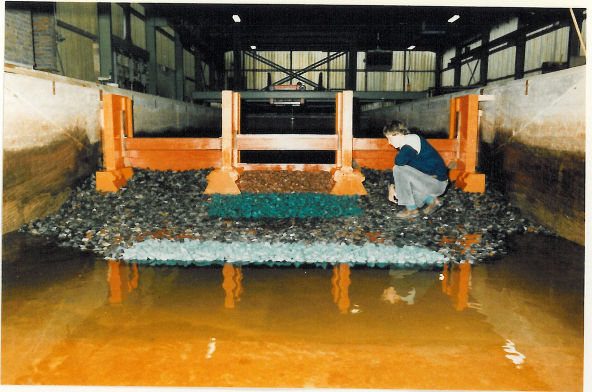
1a Proefopstelling dorpelniveau N.A.P. - 4,5 m
