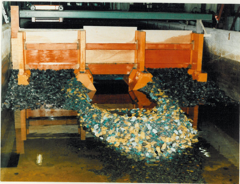
3b Bezwijken van de drempel bij dichte kering, verval 24 m (T38)
