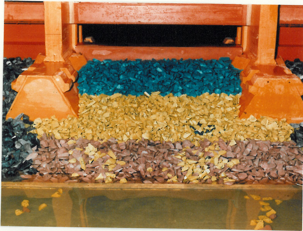
2a Beeld van de schade bij de huidige toestand, verval 4,9 m (T3)
