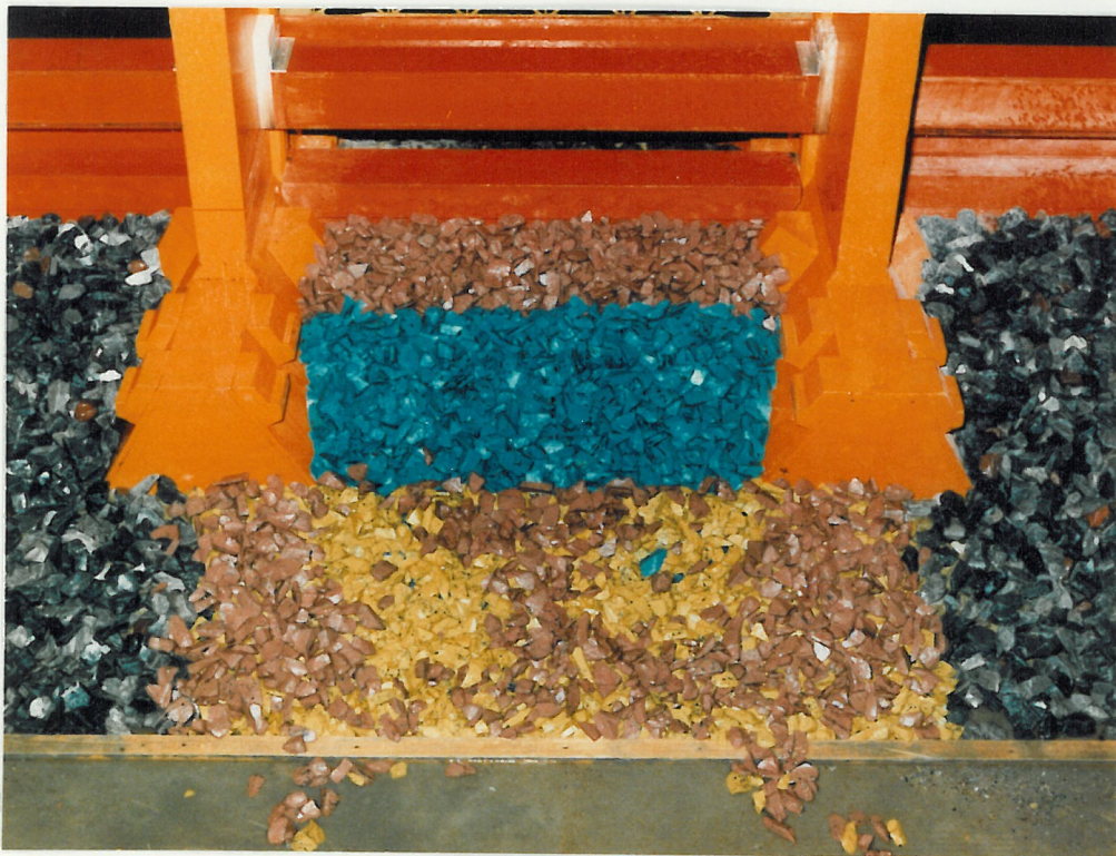
2b Beeld van de schade met een afdeklaag, verval 6,3 m (T20)
