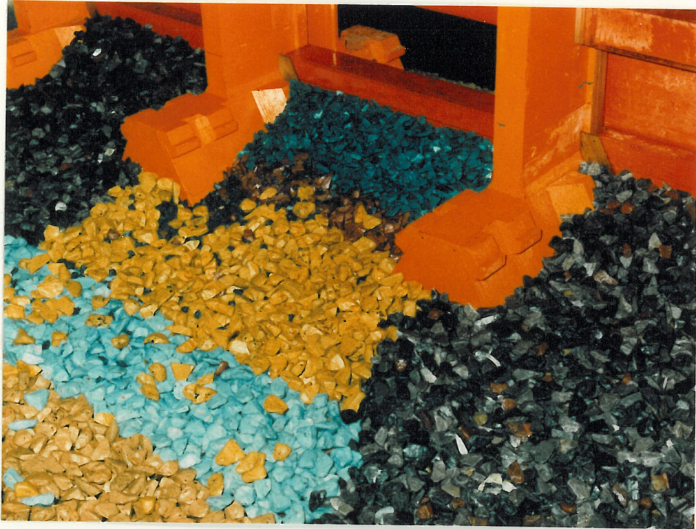
3a Beeld van de schade bij een halve AOS, verval 7 m (T27)
