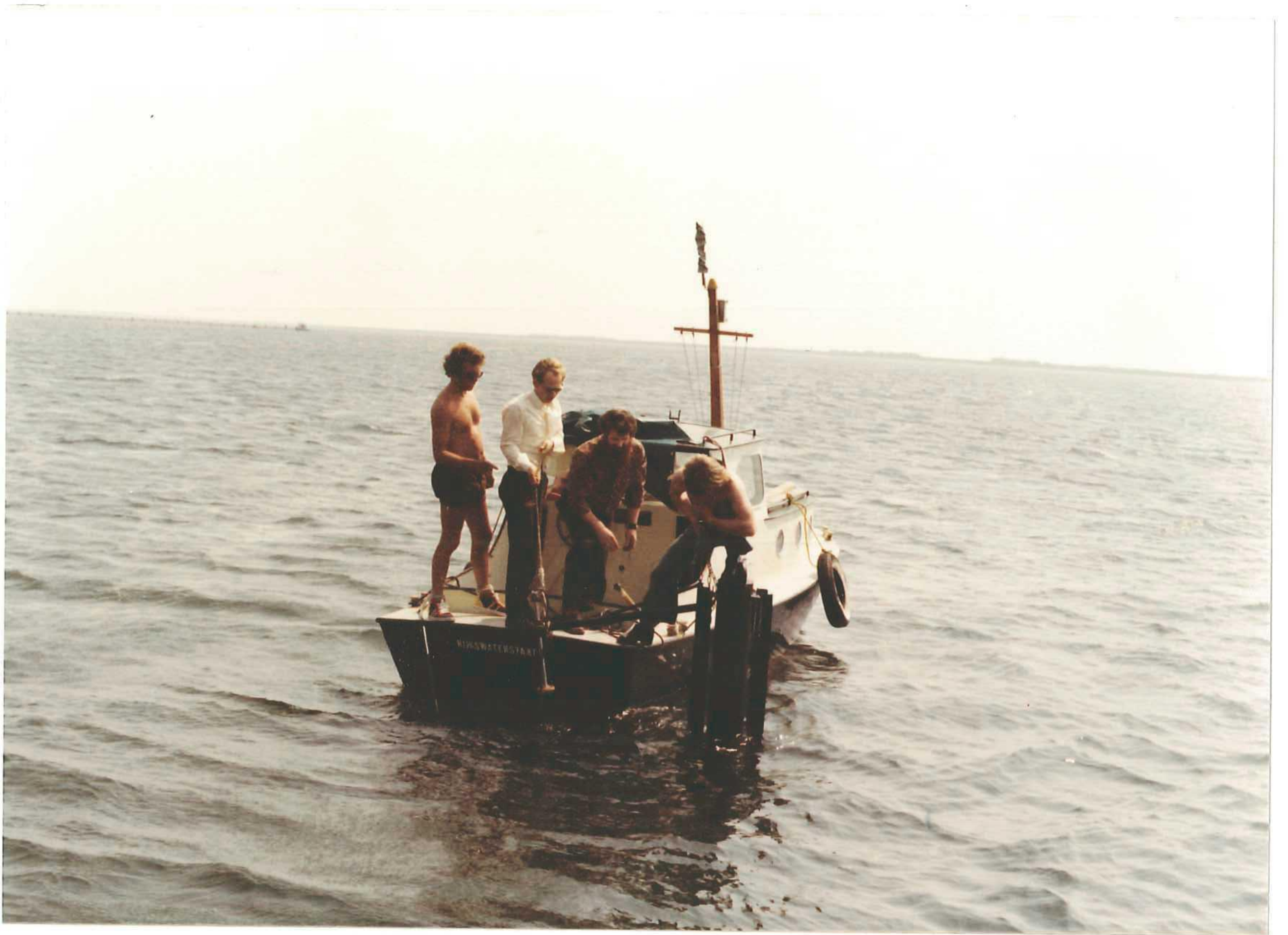
foto 3: het overbrengen van de stroommeter naar een andere meetpaal
