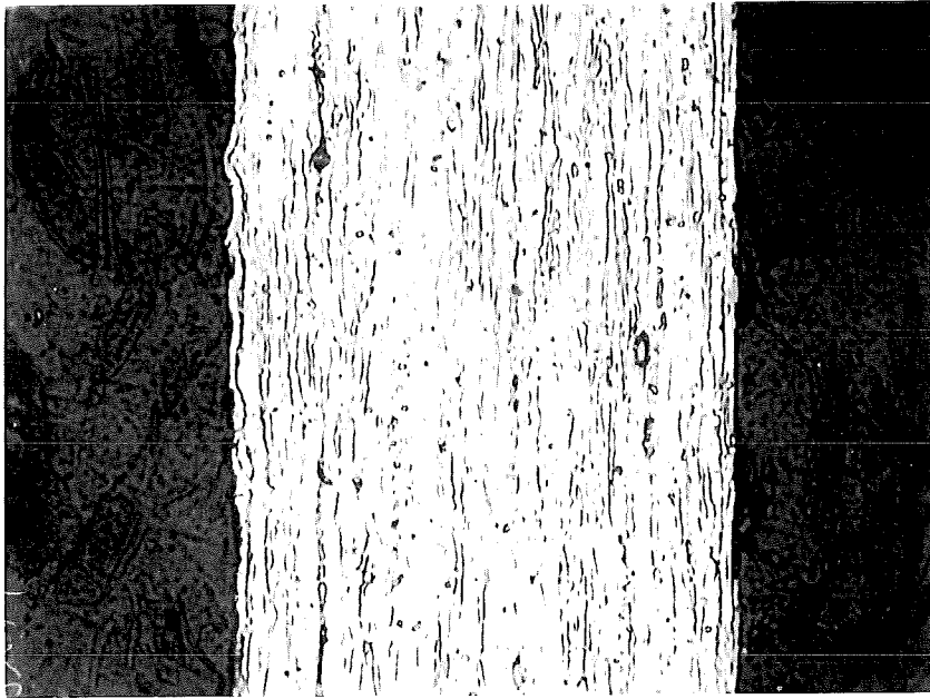
No.1. structuur van koudgewalst koper. vergroting 600 x
