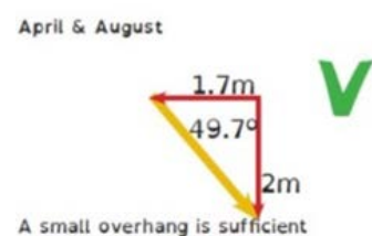
Fig.6: Minimaal overstek dat nodig is als zonwering (Roelvink, K.)
