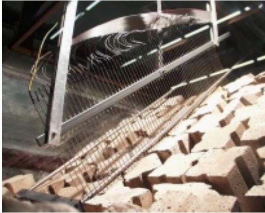
Figuur 7: De nieuwe digitale golfploopbaak geïnstalleerd op het model van de Zeebrugge golfbreker in de golfgoot van het Waterbouwkundig Laboratorium van Borgerhout.
