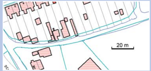
Figuur 9.3 Verschil tussen topografische en kadastrale sloot
