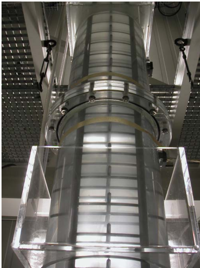
Figuur 2.9 Slibkolom in het laboratorium voor vloeistofmechanica in de Universiteit Delft (foto: Francesca Mietta)
