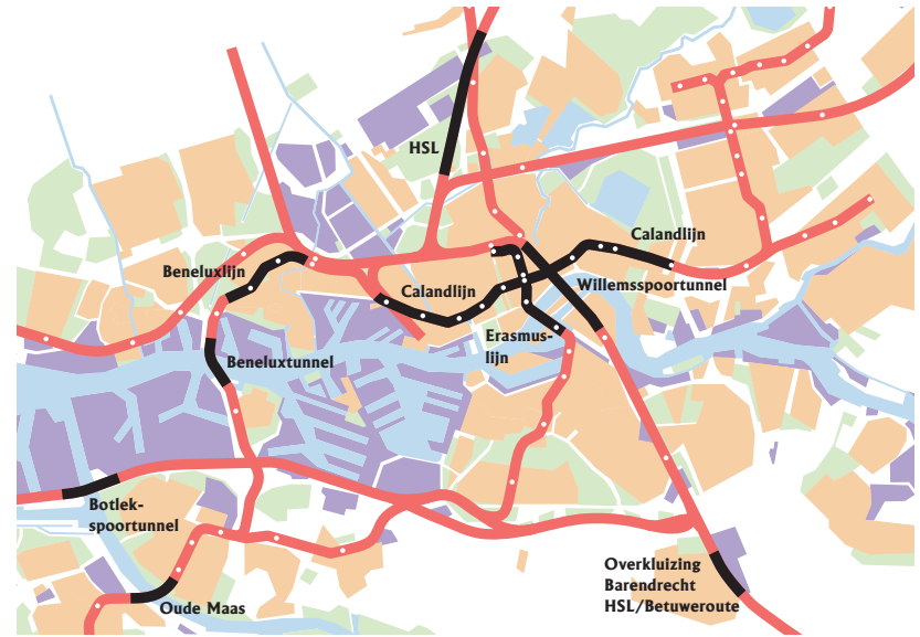
Ondergrondse verkeersruimte voor het railnet in Rotterdam
