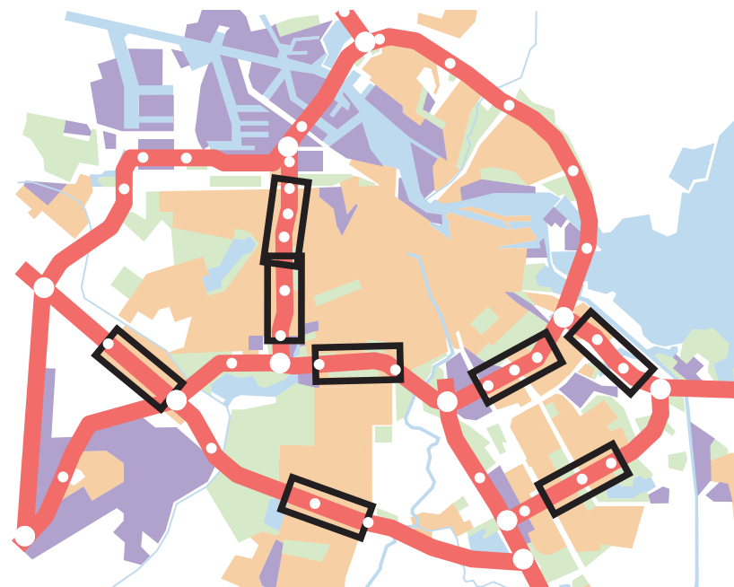
Stel: een ondergrondse stadstraverse mag uit oogpunt van ruimtelijke beleving niet langer worden dan 2,5 km, Ring Amsterdam
