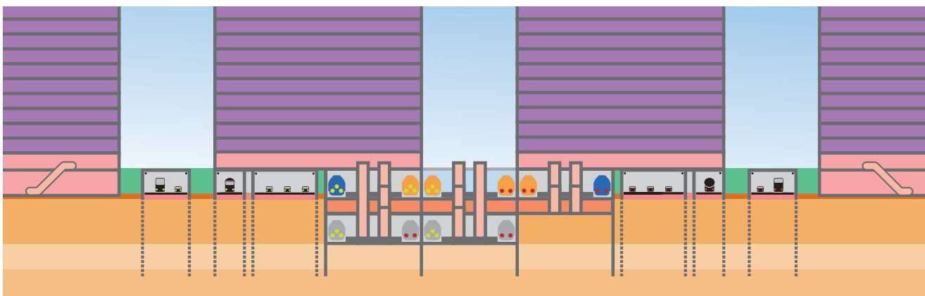
Gecombineerde overbouwing van delen van het railstation en de snelweg
