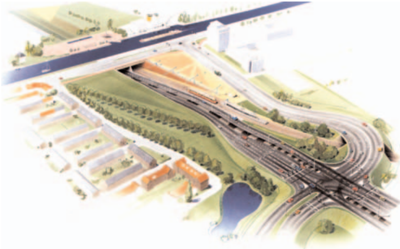
NORAH Gecombineerde weg- en tramtunnel onderlangs de Vliet
