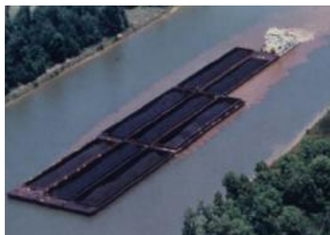
Afbeelding 4.11. Opwerveling bodemmateriaal door een duwstel.
