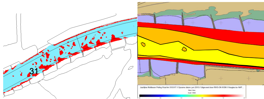
Afbeelding 5.2. Kleine ondiepten (links) en resultaat in een waterdiepte kaart (rechts)
