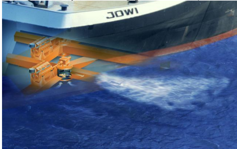
Afbeelding 2.12 Kanalsystemen met aanzuiging vanuit de onderkant (Bron: www.veth-motoren.com )
