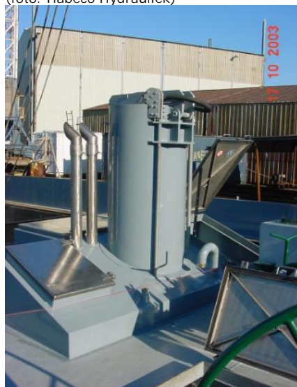
Afbeelding 2.9. Foto's van de behuizing en de kop van een spudpaal
