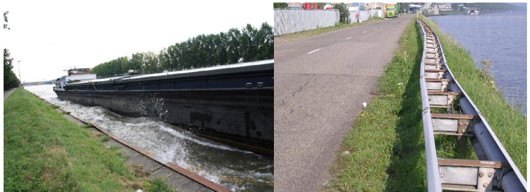
Afbeelding 4.11. Opwerveling bodemmateriaal door een duwstel.
