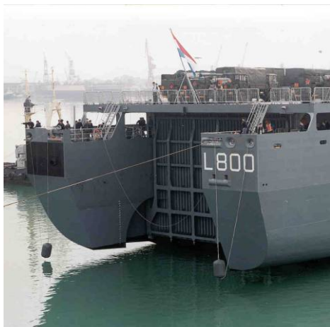
Figuur 15: Achterzijde ATS met verlengde constructie aan weerszijde van de achterklep
