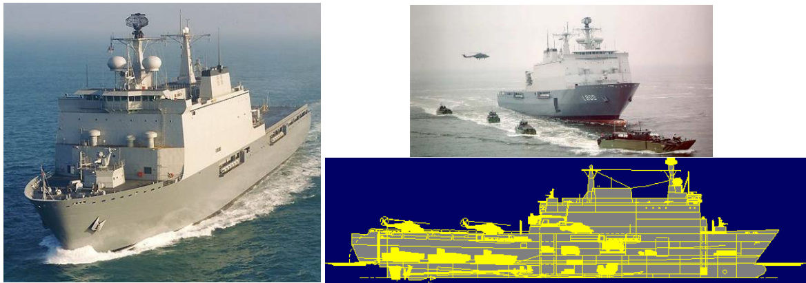
Figuur 13: Het Amfibisch Transportschip (ATS) van de Koninklijke Marine met eigen dokcapaciteit voor vervoer- en laden en lossen van landingsboten
