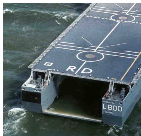
Figuur 15: Achterzijde ATS met verlengde constructie aan weerszijde van de achterklep
