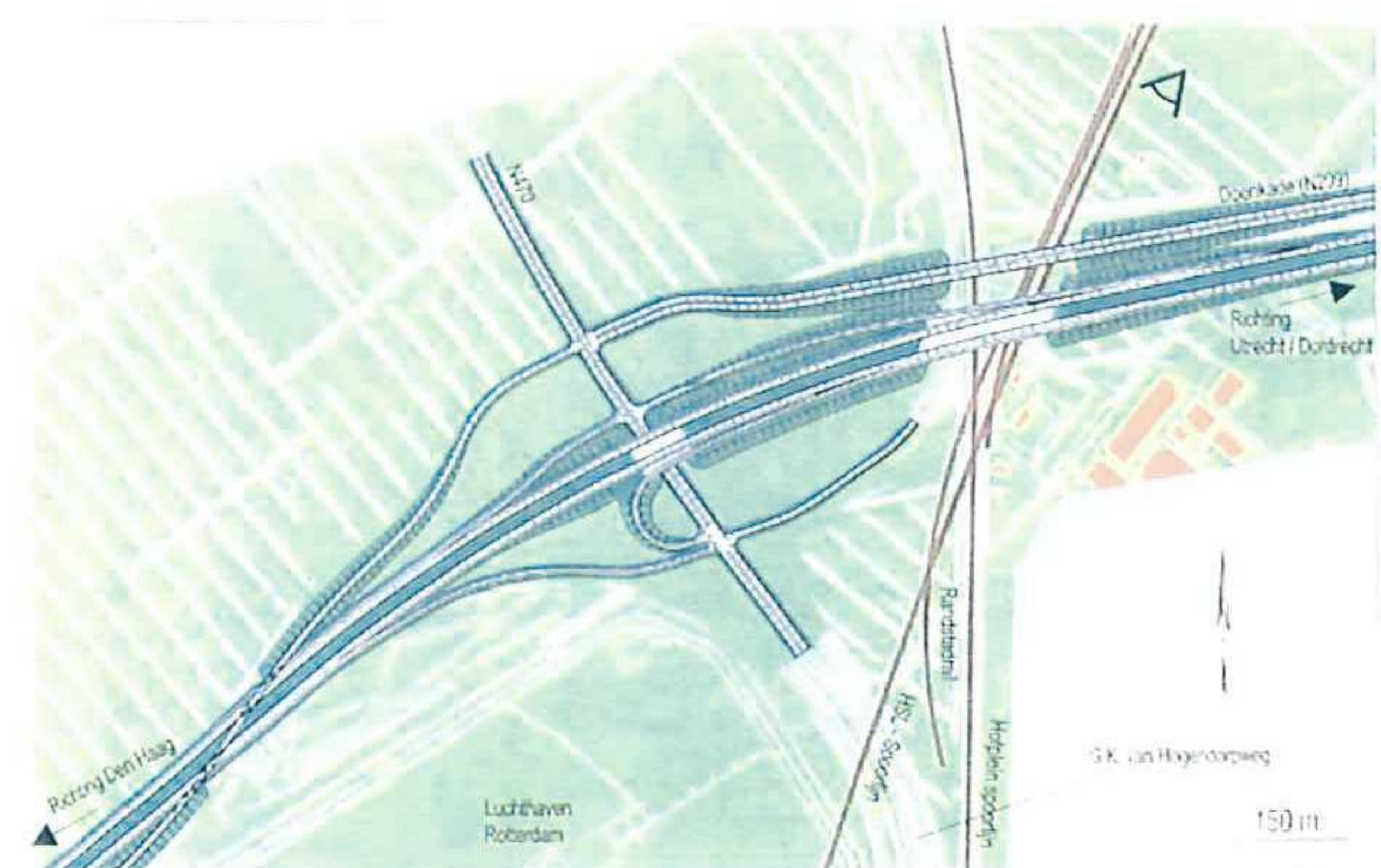
figuur 10.2 schets bovenaanzicht afslag AirportCity op Rijksweg 16/13 bron: Rijkswaterstaat directie Zuid-Holland, tracé/m.e.r.-studie RW 16/13, 1999
