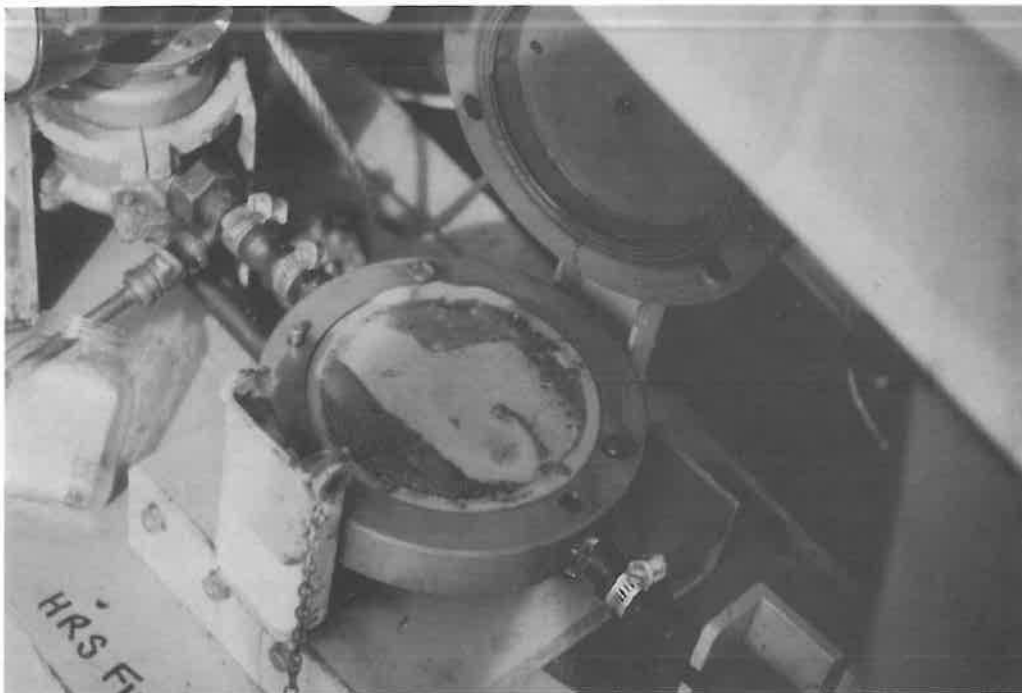
6 Filtreerdoek (40 \mu\text{m} ) met het gevangen sediment
