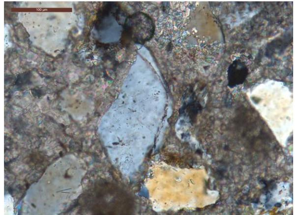
(d) S11. Syntaxial overgrowth on a monocrystalline quartz grain.
