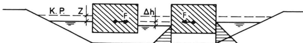
Figuur 4.17. Hydrostatische druk bij een inhaalmanoeuvre
