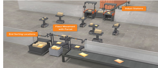
(d) GreyOrange Flexo, crossbelt conveyor AGVs [86]
