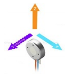
Figure 3.7: Een lineaire resonantie actuator trilt tegen de huid
