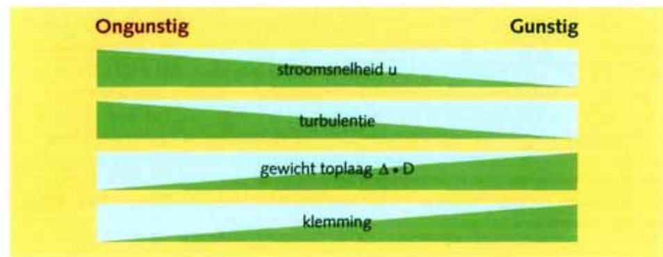
Figuur 3.5 Parameters langstroming
