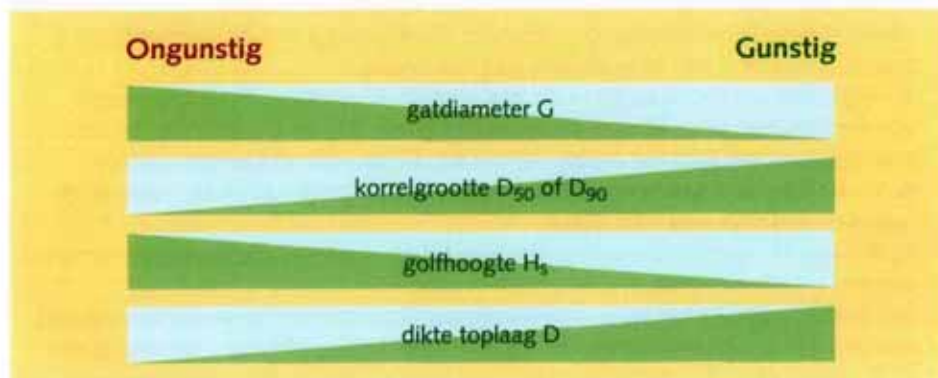
Figuur 3.14 Parameters materiaaltransport granulaire laag > toplaag
