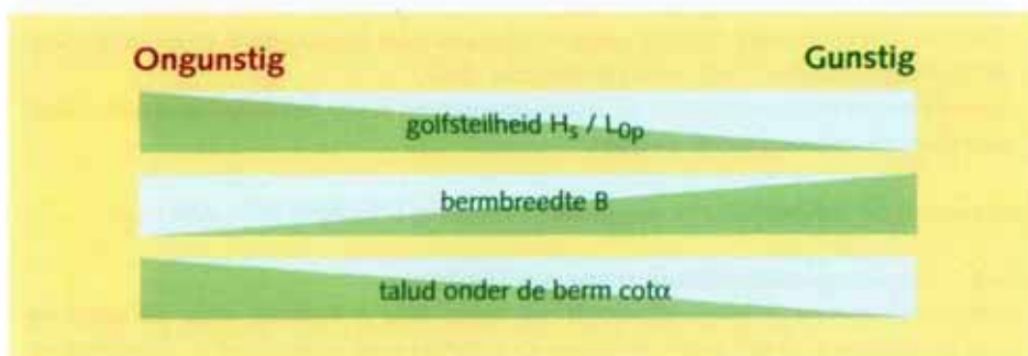
Figuur 3.6 Aanvullende parameters steenzetting op berm
