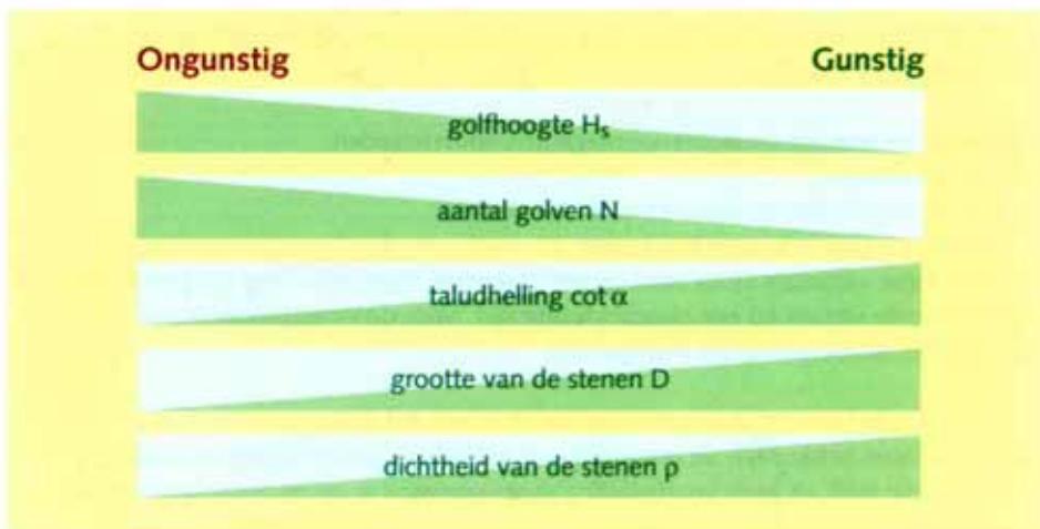
Figuur 3.16 Parameters breuksteenoverlaging
