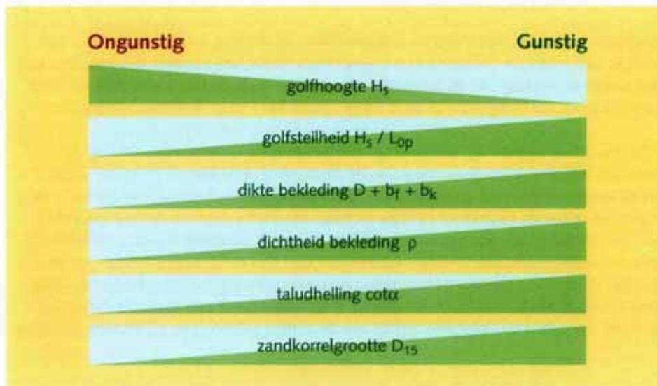
Figuur 3.9 Parameters afschuiving
