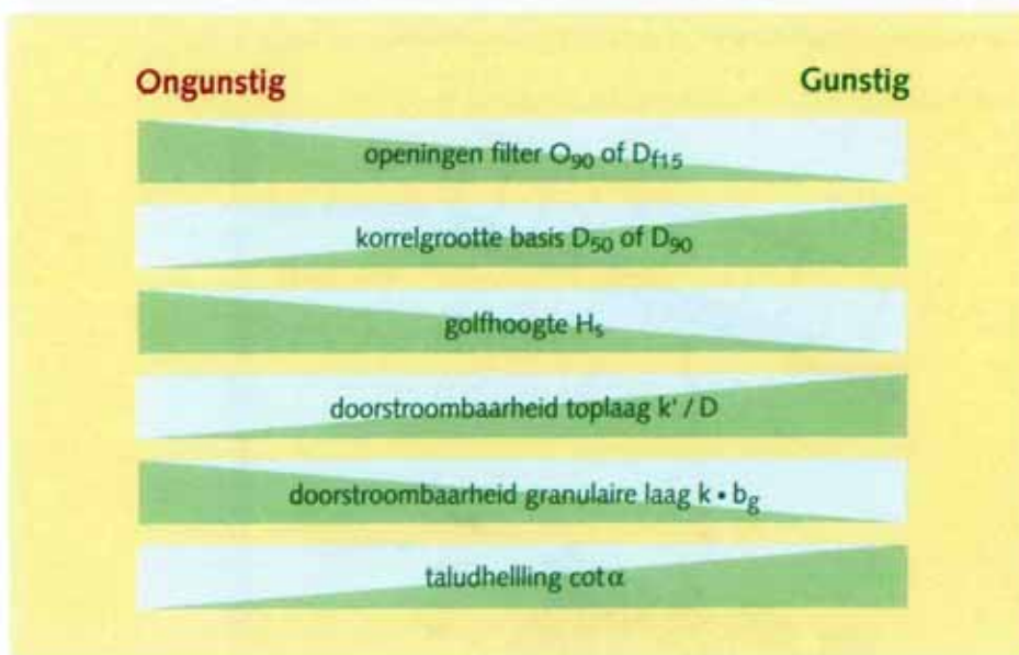
Figuur 3.12 Parameters materiaaltransport ondergrond > granulaire laag
