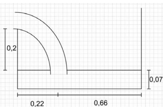
Figuur 7: Afmetingen spoelgoot
