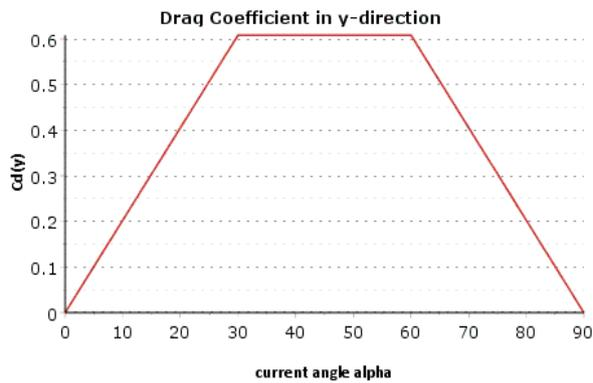
Figure 69 Drag Coefficient  $C_{d(y)}$  from[literatuur benomen]
