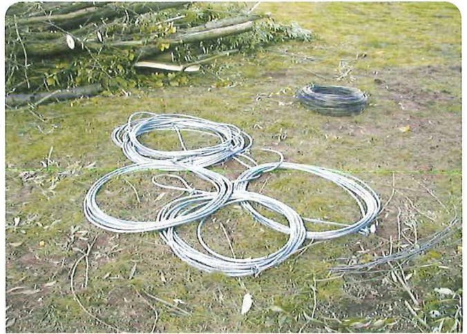
Bild 2.6.3.1: Stahlseile, 12 mm stark zur Befestigung von Raubäumen, beglühter Draht, 3 mm stark zum Binden von Faschinen
