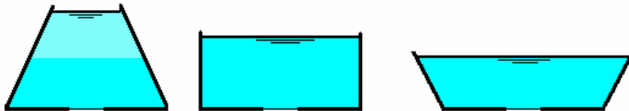
Figuur 7-3-1: Effect van het verloop van de wanden op de drukhoogte t.p.v. de uitstroomopening
