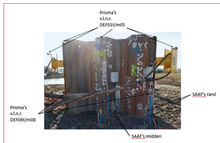
Figuur 6 - Monitoring instrumentatie horizontale verplaatsingen bij Pullover Test op AZ26 paneel.
