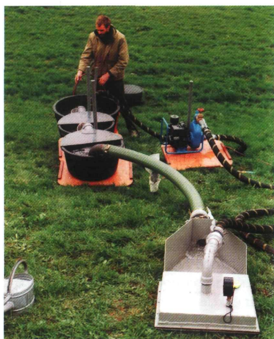
figuur 3.6: Proefopstelling sproeikopproef (Bron: Landbouw Universiteit Wageningen)
