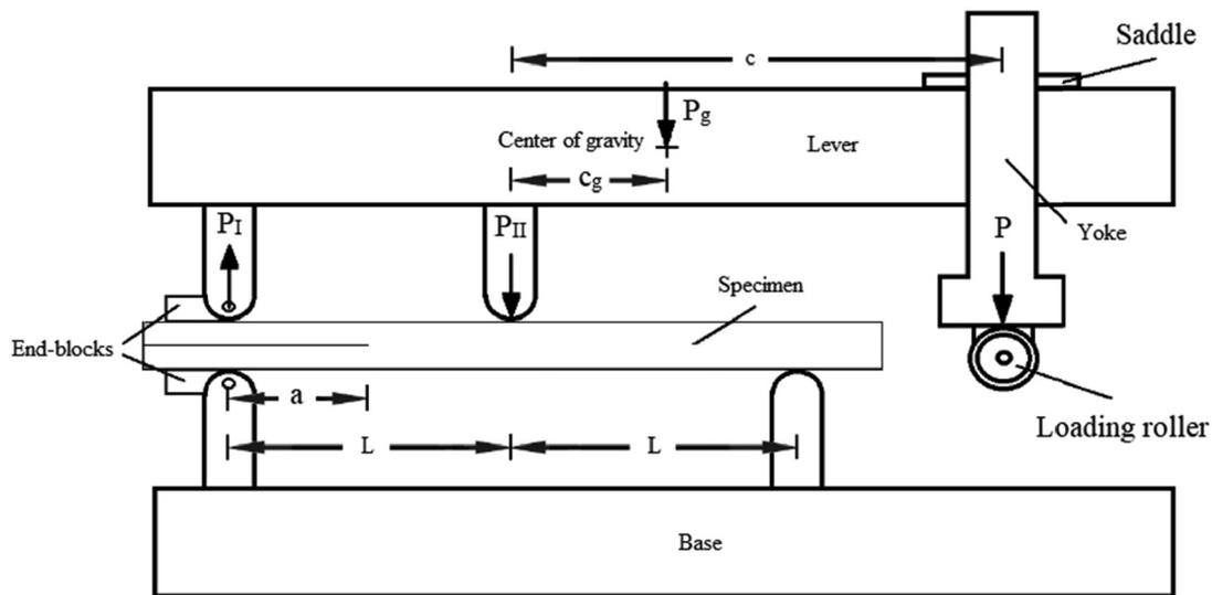
**Fig. 1.** MMB test scheme.
