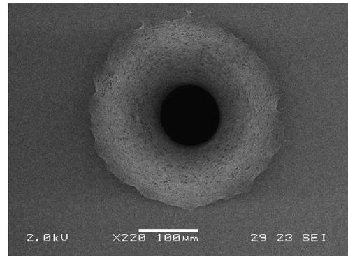
**Fig. III: T<sup>3</sup>μPS micronozzle (UTwente),**
