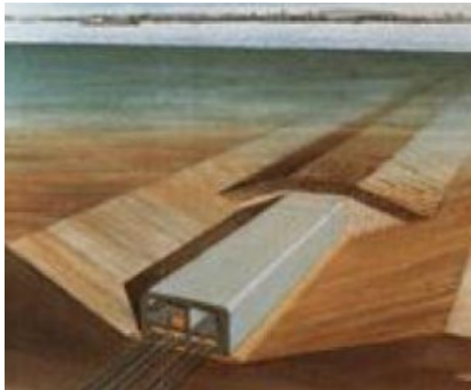
Figuur 8: Gedeeltelijk aangevulde zinksleuf [33]
