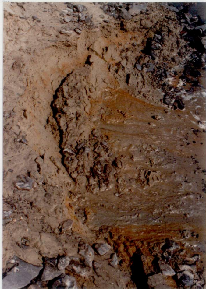
foto 9 Uittredend water uit zand aan onderkant mijnsteen (roestkleur)
