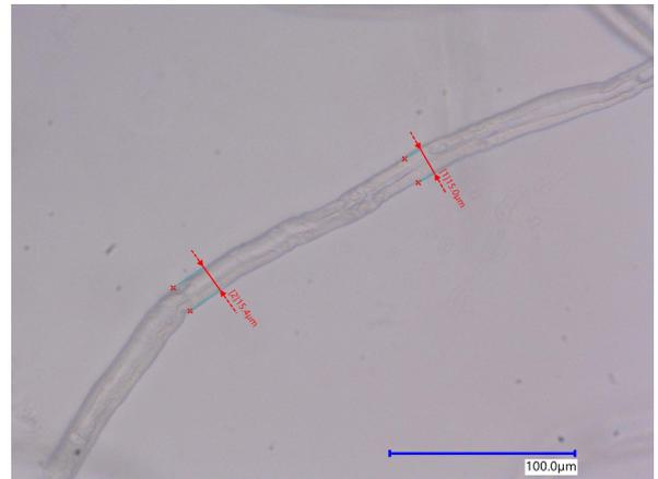
(d) A measurement of fFSF fiber width (1000x magnification).
