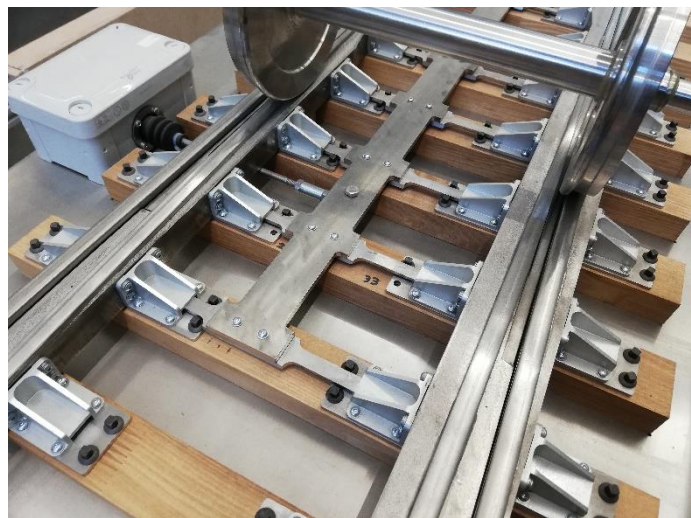
Figuur 2.9 Verticaal beweegbare elementen zijn te zien in de groeven (Mortier, 2021)
