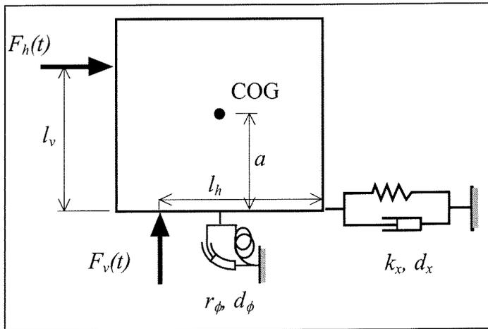
**Figure 6-1 Spring dashpot model**
