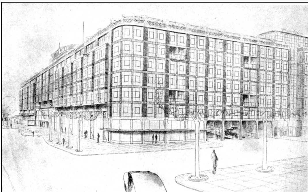
Afbeelding 4.2.113: de gevels, getekend in 1948, aan het Stationsplein met de erkers en een vlakke gevel boven de hoofdingang en aan de Conradstraat met balkons. Maaskant, H. A. en W. van Tijen, 'De betekenis van het Rotterdams Groothandelsgebouw', Polytechnisch Tijdschrift , (1949) 11/12, pp. 171b-177b.
