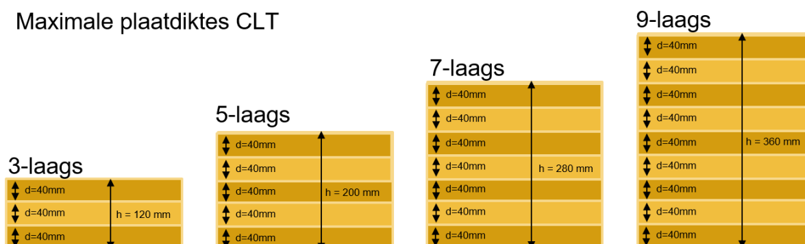
Figuur 3.4: Overzicht van maximale praktische plaatconfiguratie per aantal CLT-lagen
