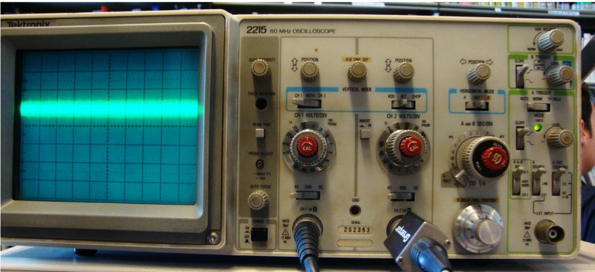
Figuur B5.3: Tektronix 2215 Oscilloscope
