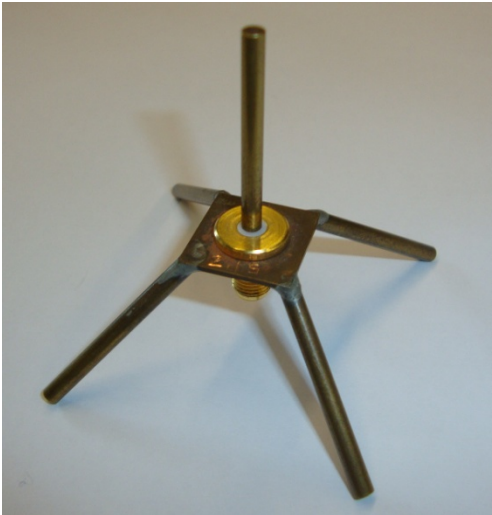
Figuur B5.7: Monopoolantenne
