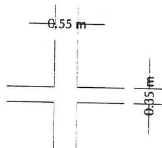
Afbeelding 6.5 Schematisatie kruisingen van de caissonwanden
