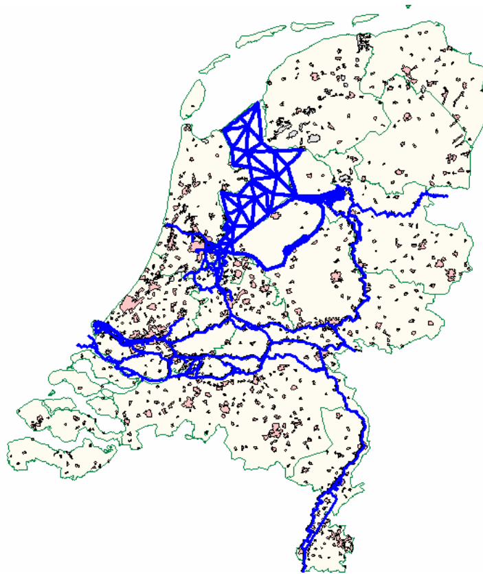
Figuur 5 Schematisatie van het landelijk temperatuurmodel (gebaseerd op het Nationaal Sobek model)
