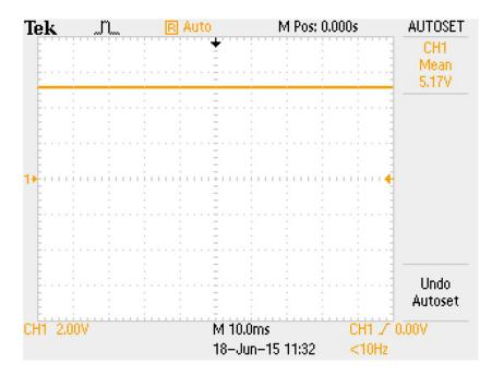
Figure C.15: Mean value of  $V_{\text{REGIN}}$ .
