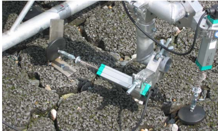
Foto 6-1 Meting van vervorming in het vlak van de zetting (XY meting)
