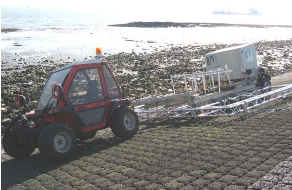
Foto 4-7 Opstelling trekproeven: verticale en enkelsteens proeven
