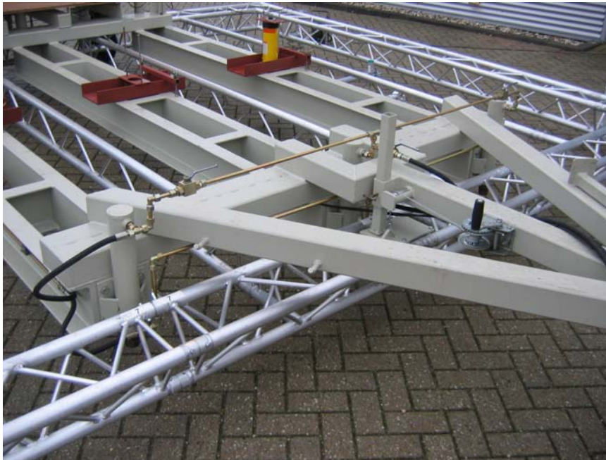
Foto 4-2 Meetkar. Krachtsframe (gespoten staal), dissel (triangel), hydraulische stempels met kraantjes, proefvijzel (geel) en meetframe (aluminium) zichtbaar. Met het liertje kan het meetframe worden gehesen en gevierd.
