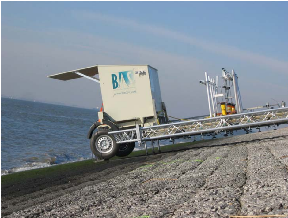
Foto 4-6 Opstelling trekproeven: driesteens horizontale proeven in Bath
