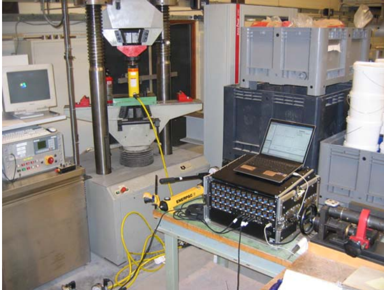
Foto 4-5 Opstelling testen druksensoren
