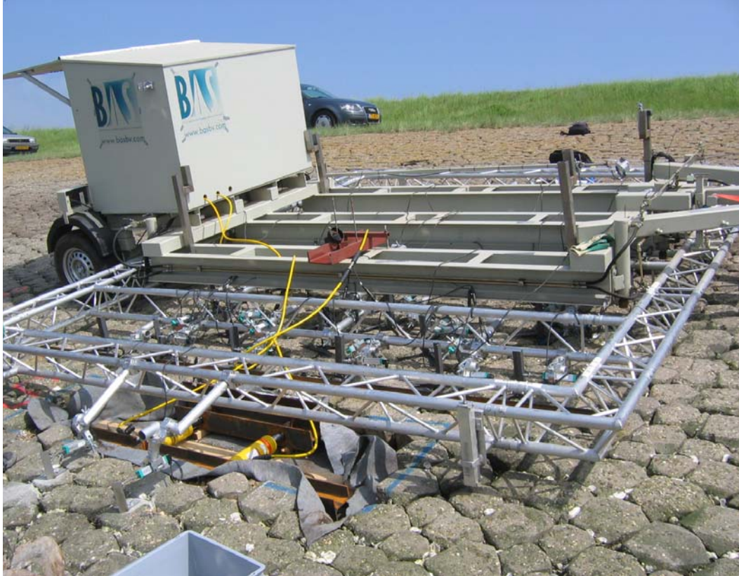
Foto 4-8 Opstelling schuifproeven (voorbeeld Poortvliet, proef smal en laag)
