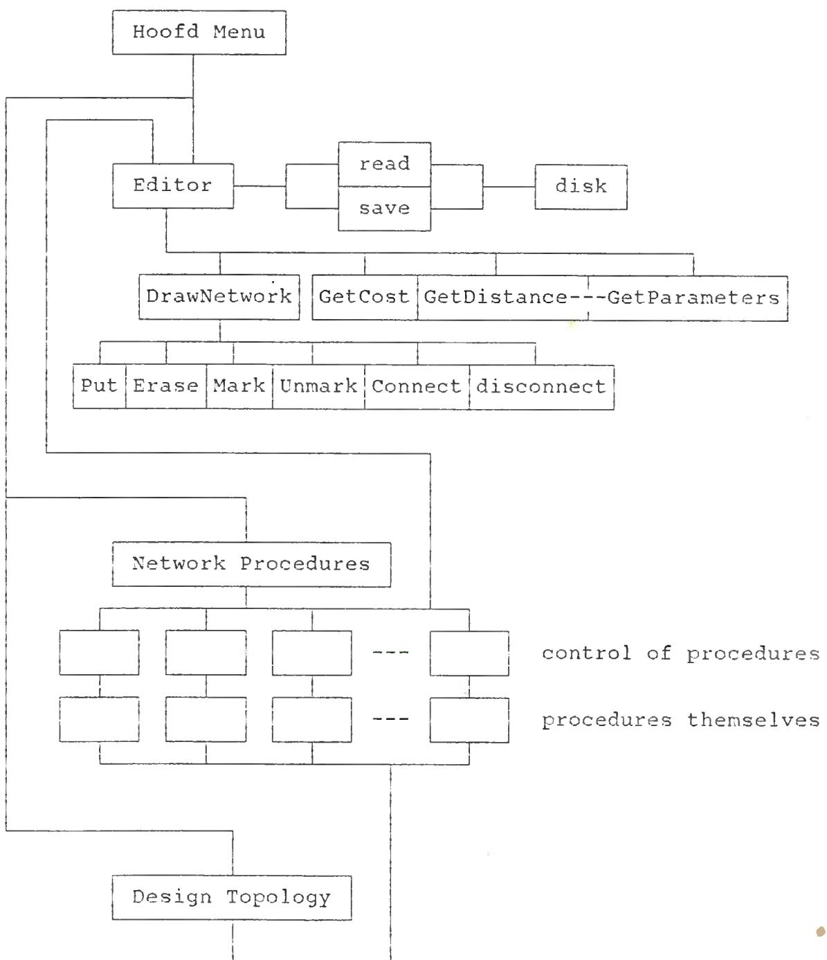
figuur 1. Verbindings-diagram.
